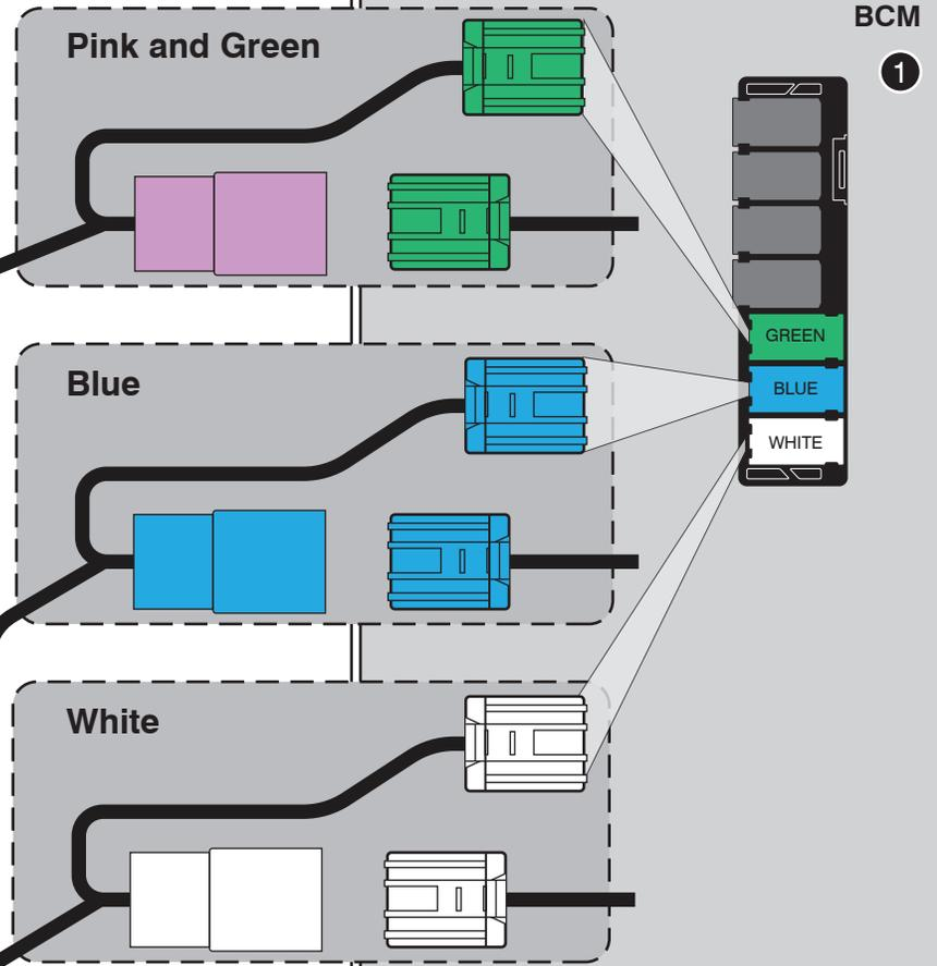
**E** La instalación de tipo 6 requiere un pulso ACC con desarmado para controlar adecuadamente el sistema de alarma OEM. Establezca la opción de función 1-11 en la opción 3 (Pulso ACC, mismo tiempo que pulso desarmado)
